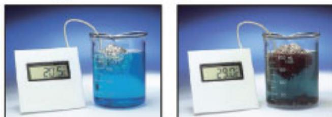
۴۲۹. شکل مقابل واکنش میان آلومینیم و مس (II) سولفات را نشان می‌دهد، با توجه به آن به پرسش‌ها پاسخ دهید. ( $\text{Al} = 27, \text{Cu} = 64; \text{g.mol}^{-1}$ )
