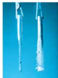
تغییر جرم تیغه‌ها پس از کارکردن در سلول گالوانی روی - مس
