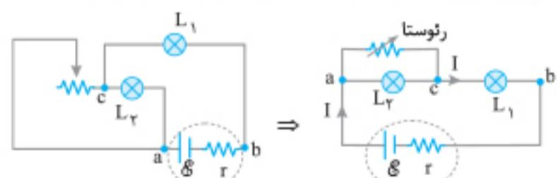
دقت کنید که اگر توان مصرفی لامپ افزایش یابد نور لامپ زیاد و اگر توان مصرفی لامپ کاهش یابد، نور لامپ کم می‌شود. بنابراین وقتی لغزنده به سمت چپ حرکت می‌کند، طول بیشتری از مقاومت در مدار قرار گرفت و طبق رابطه  $R = \rho \frac{L}{A}$ ، مقاومت روستا افزایش می‌یابد. بنابراین مقاومت معادل کل مدار نیز افزایش یافته و جریان شاخه اصلی ( $I$ ) کاهش می‌یابد. با کاهش  $I$  که همان جریان عبوری از لامپ  $L_1$  نیز هست، توان مصرفی لامپ  $L_1$  کاهش یافته و کم نور می‌شود. همچنین با توجه به رابطه  $V_1 = R_1 I_1$
