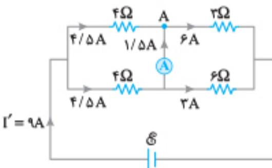
با افزایش مقاومت  $R_3$ ، مقاومت معادل مدار افزایش می‌یابد، در نتیجه بتا به رابطه  $I = \frac{6}{R_{eq} + r}$ ، جریان کل مدار کاهش خواهد یافت. با کاهش جریان کل مدار، بتا به رابطه  $V_1 = R_1 I$ ، اختلاف پتانسیل دو سر مقاومت  $R_1$  کاهش و بتا به رابطه  $V = 6 - rI$ ، اختلاف پتانسیل دو سر مدار (دو سر باتری) افزایش می‌یابد.
