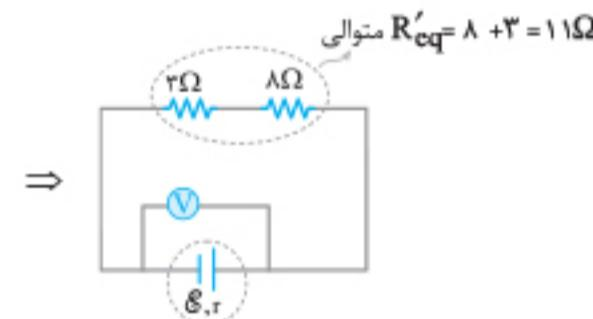
بنابراین با تغییر مقاومت ۳ اهمی به ۶ اهمی، مقاومت معادل مدار از  $10\Omega$  به  $11\Omega$  تغییر می‌کند. پس جریان کلی مدار کاهش می‌یابد. بنابراین طبق رابطه  $V = \mathcal{E} - rI$  و با توجه به ثابت بودن  $\mathcal{E}$  و  $I$  و کاهش  $r$ ، افزایش خواهد یافت. با توجه به این که جریان کلی مدار کاهش یافته و مقاومت شاخه‌ای که آمپرسنج در آن است از  $2\Omega$  به  $6\Omega$  افزایش یافته، جریان گذرنده از این شاخه کاهش یافته و آمپرسنج عدد کمتری را نشان می‌دهد.
