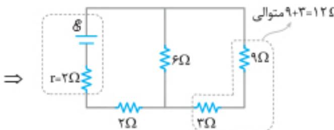
دقیت کنید که جریان  $4X$  گذرنده از مقاومت  $2\Omega$  در مدار اولیه، همان جریان گذرنده از مقاومت معادل مقاومتهای  $26\Omega$  و  $12\Omega$  است. حالا با توجه به موازی بودن مقاومتهای  $12\Omega$  و  $6\Omega$  می‌توان نوشت:
