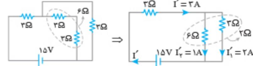
چون جریان A ۳ بین دو مقاومت موازی ۳ و ۶ اهمی متناسب با وارون مقاومت ها تقسیم می شود، پس می توان دریافت:  $I'_Y = 1A$ ,  $I'_1 = 2A$ . بنابراین  $I'_2$  تغییر نمی کند، اما  $I_1$  دو برابر می شود.
