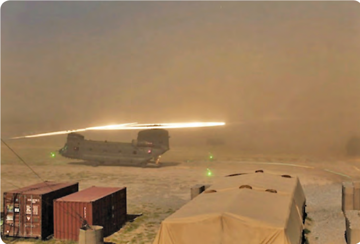
وقتی پره‌های فلزی هلی‌کوپتر می‌چرخد، در اثر مالش، بار زیادی روی آن جمع می‌شود که پس از مدتی به هوا تخلیه می‌شود. جرقه‌های این تخلیه الکتریکی، در تاریکی شب کاملاً قابل مشاهده است.
