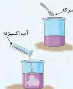
برای سفید کردن خمیر کاغذ، از موادی مانند کلر، آب‌ژاول (سفید کننده)، آب اکسیژنه و ... استفاده می‌شود. در آزمایش‌های پایین مثال‌هایی برای از بین بردن رنگ کاغذ و یا رنگ پتاسمیم پرمنگنات، آورده شده است.
