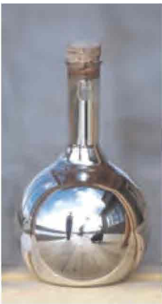
تشکیل آینه نقره‌ای هنگام اکسایش متانال \text{Ag(s)}
