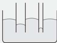
شکل جیوه در لوله‌های مویین با قطرهای مختلف
